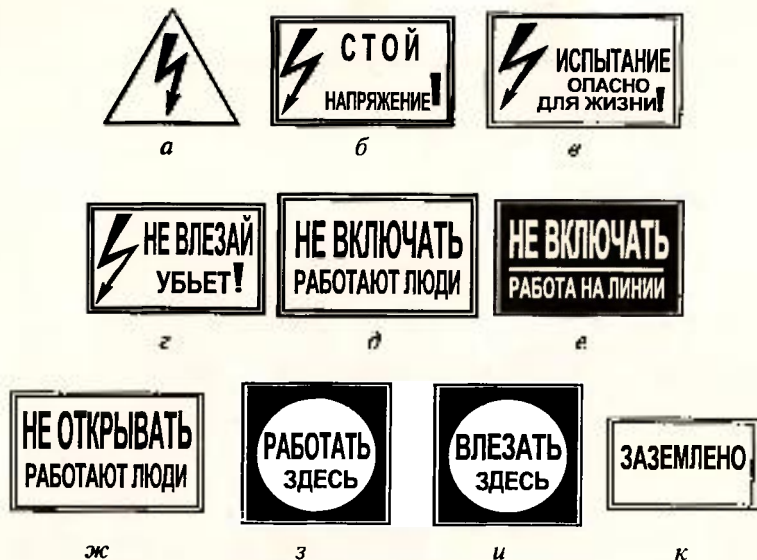
Рис. 15.1. Плакаты по требованиям безопасности и знаки безопасности: а...г — предупреждающие; д, е, ж — запрещающие; з, и — предписывающие; к — указательный
