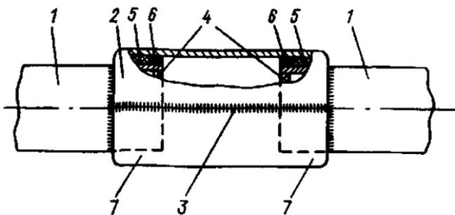
Рис. 8.2. Соединение при помощи разрезной муфты
