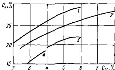
Рис. 6.7. Влияние концентрации сухого вещества в исходном осадке на эффективность задержания (центрифуга противоточная) при концентрациях сухого вещества в исходном осадке
