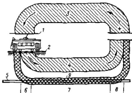
Рис. 3.14. Схема действия блуждающих токов
