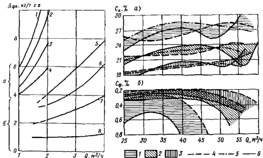
Рис. 6.10. Влияние производительности центрифуг на требуемую дозу флокулянта
