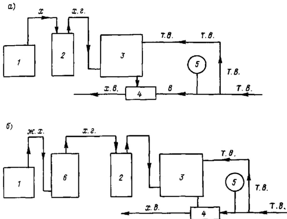
Рис. 4.1. Принципиальные схемы оборудования хлораторных
