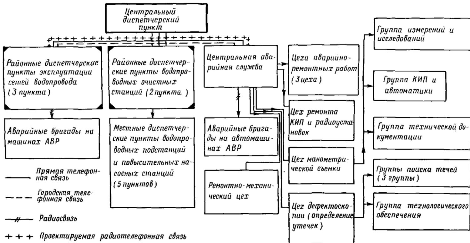
Рис. 1.2. Структура диспетчерской службы управления «Водоканал» Ленгорисполкома
