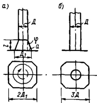
Рис. 3.1. Устройство диафрагмы всасывающего трубопровода
