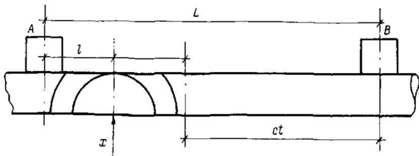
Рис. 3.12. Определение течи на трубопроводах корреляционным методом
