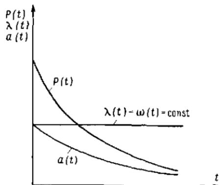
Рис. 2.2. Зависимости  $P(t)$ ,  $\lambda(t)$ ,  $a(t)$  для экспоненциального закона
