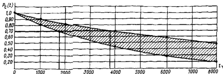
Рис. 2.7. Определение предела гарантированной работы
