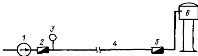
Рис. 3.7. Схема определения утечки воды водомерами
