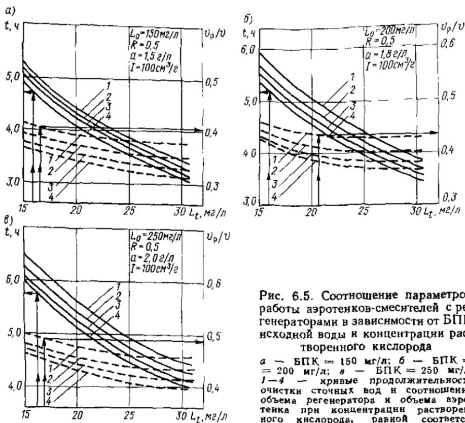
Рис. 6.5. Соотношение параметров работы аэротенков-смесителей с регенераторами в зависимости от БПК исходной воды и концентрации растворенного кислорода
