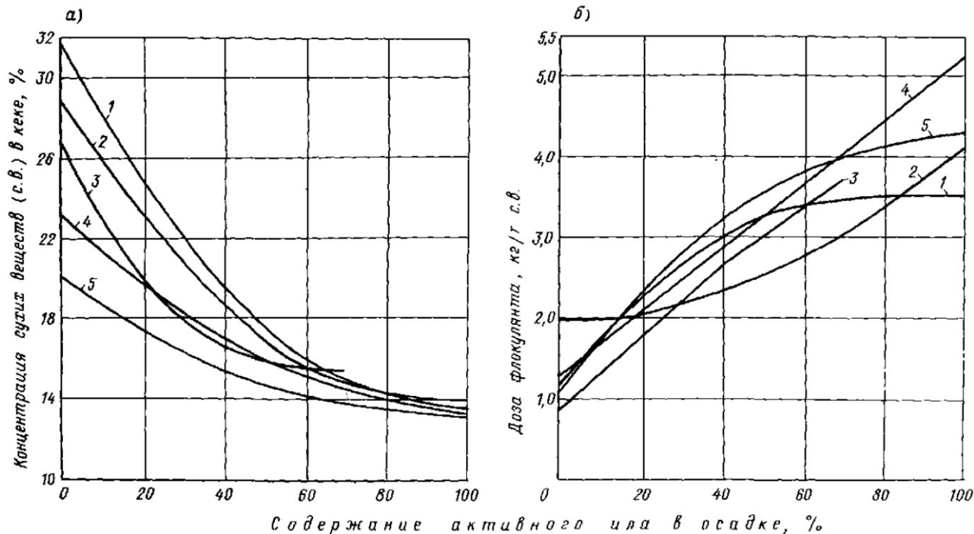
Рис. 6.6. Изменение концентрации обезвоженных осадков (а) и потребной дозы флокулянта (б) в зависимости от содержания активного ила в центрифугируемых осадках (прямоточные центрифуги)
