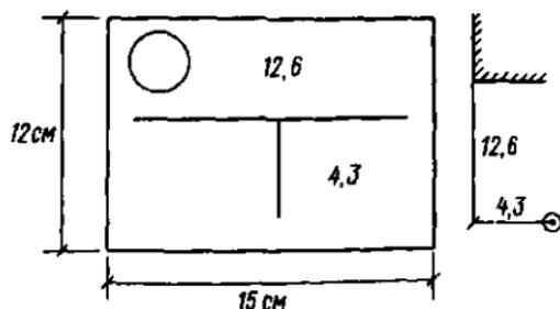
Рис. 5.3. Координатные таблички для канализационных колодцев
