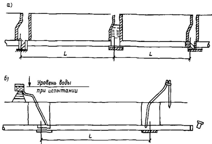
Рис. 5.2. Гидравлическое испытание канализационных линий на утечку воды из трубопровода
