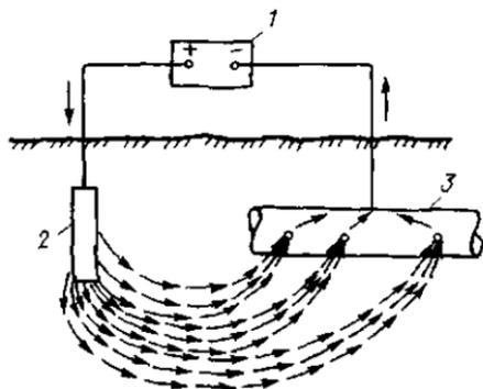
Рис. 3.13. Принцип действия катодной защиты
