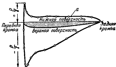
Фиг. 112. Распределение давления по профилю.
