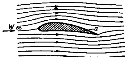
Фиг. 109. Линии тока при обтекании профиля в первый момент после возникновения течения.
