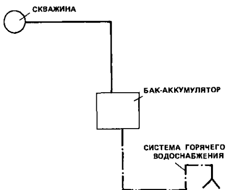
Рис. 17.4. Схема с непосредственной подачей геотермальной воды только на горячее водоснабжение
