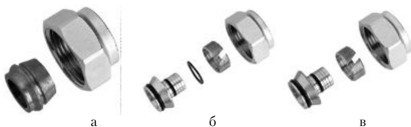
Рис. 32. Фитинги «Данфосс» для труб: а - стальных и медных, б - PEX-AL-PEX, в - VPE/PEX
