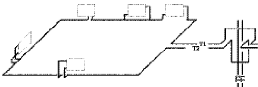
Рис. 55. Схема периметральной поквартирной однотрубной приборной ветки системы отопления
