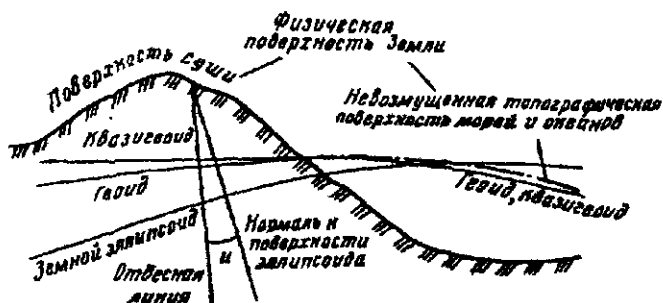
Рис. 5. Сечение физической поверхности Земли и поверхностями земного эллипсоида, геоида и квазигеоида
