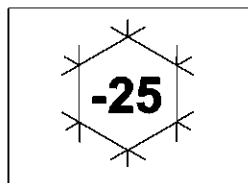
Рис. 15 Обозначение на корпусе УЗО, предназначенного для работы при температуре окружающей среды до минус 25°С.
