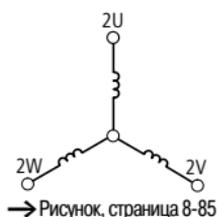
**Схема соединений двигателя Z**
