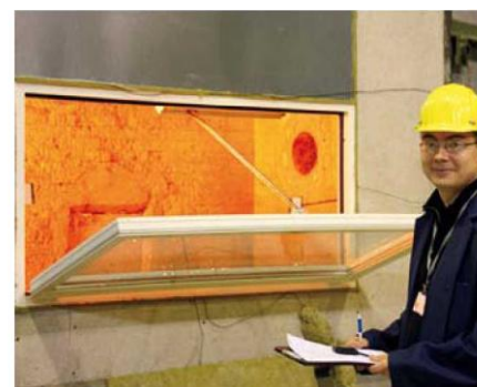
Окно дымоудаления ORI 70 SI – испытания на воздействие высоких температур (В 300)
