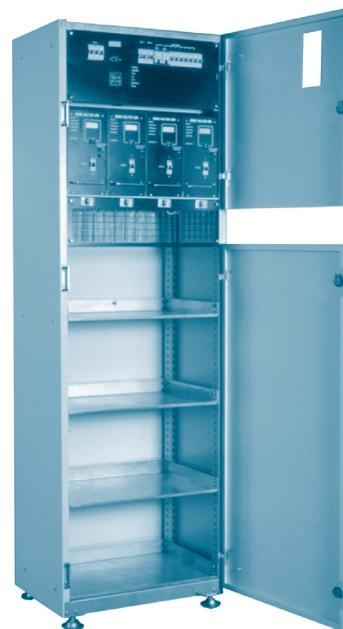
Токораспределительная часть УЭПС-2 позволяет устанавливать предохранители или автоматические выключатели в цепях нагрузки на токи 6, 10, 16, 20, 25, 32, 40, 50, 63, 80, 100, 125, 160, 200 и 250 А. Количество выключателей и их токи оговариваются при заказе.
