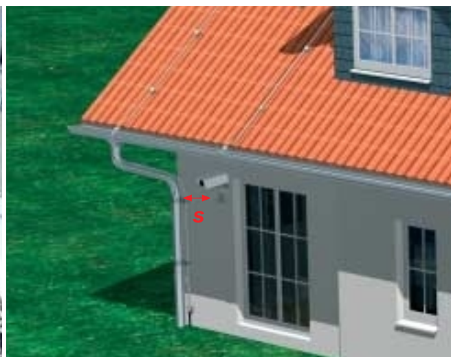
Наименьшее допустимое расстояние между токоотводящим устройством и камерой наблюдения соблюдено.
