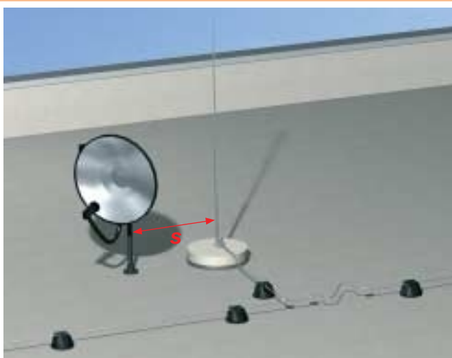
Правильно соблюденное наименьшее допустимое расстояние между молниеприемником и спутниковой антенной
