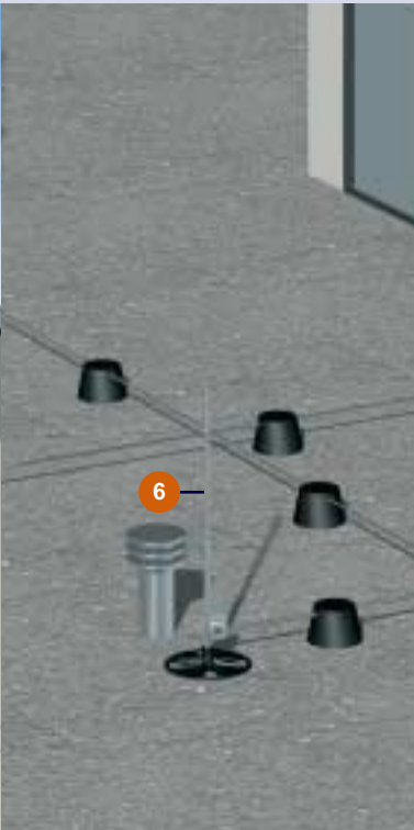
Вентиляционный канал защищен устройством FangFix-Junior
