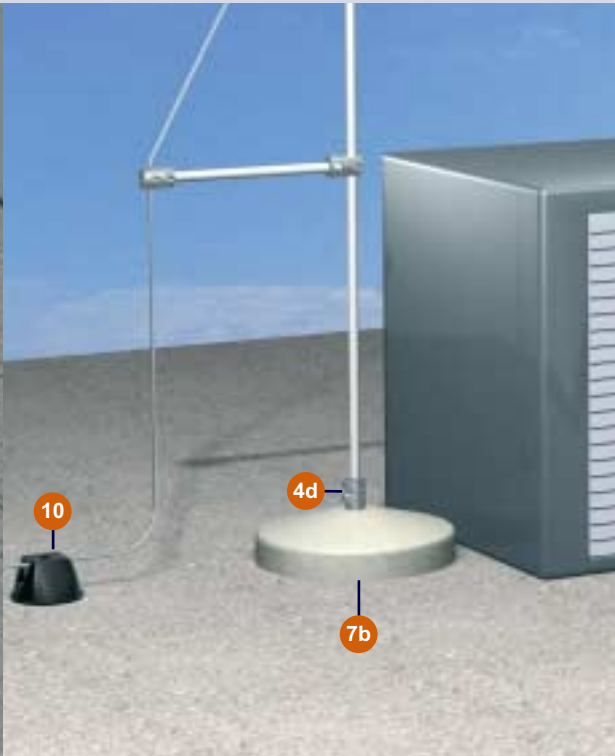
Изолированный стержневой молниеприемник на опоре
