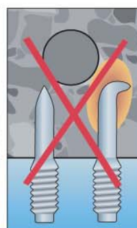
Обычное применение гвоздей: Гвоздь может согнуться при попадании на твердый камень или арматуру
