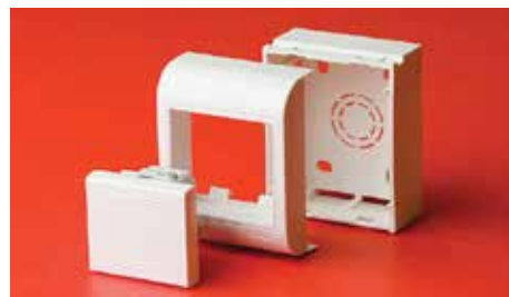
1. Коробки типа PDD для электроустановочных изделий "Viva", "Brava", 45x45 мм. В данные коробки розетки монтируются зашелкиванием (без рамок и каркасов). С 4-х сторон коробки имеют перфорацию под все типоразмеры мини-каналов серии TMC
