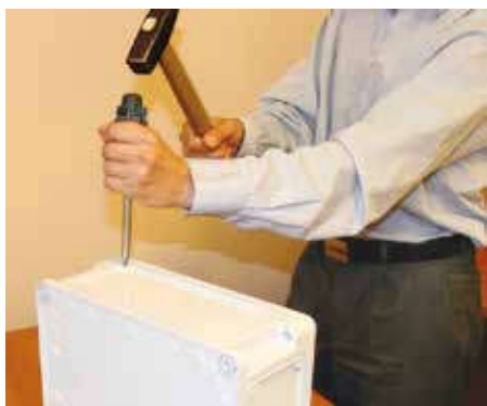
1. Удалите соединительные отверстия
