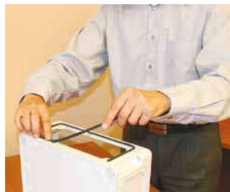
3. Установите уплотнитель на оба объединяемых корпуса
