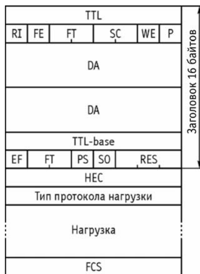
Рис. 3.143. Общая структура кадра RPR
