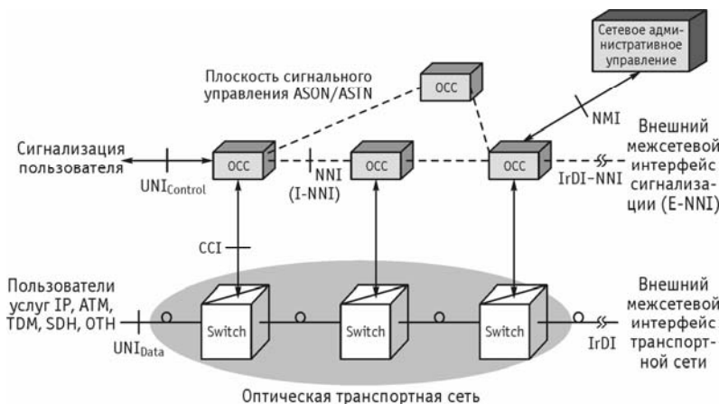
Рис. 5.54. Общая структурная модель ASON/ASTN
