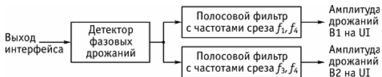
Рис. 5.32. Схема измерений фазовых дрожаний
