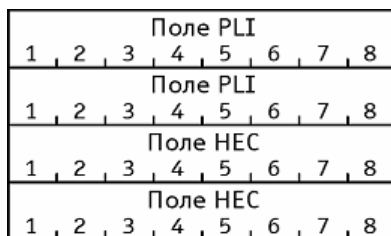
Рис. 3.132. Форматы полей заголовка кадра GFP
