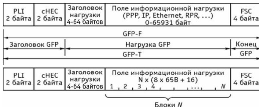
Рис. 3.139. Отличительные признаки GFP-F и GFP-T
