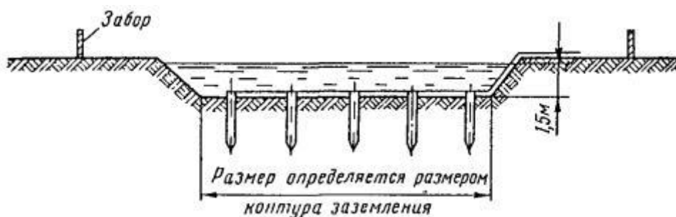
Рис. 7.1. Устройство контура заземления на дне пруда
