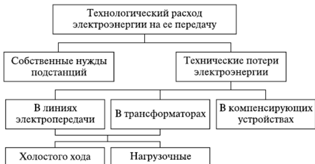
Рис. 9.1. Структура расхода электроэнергии на ее передачу
