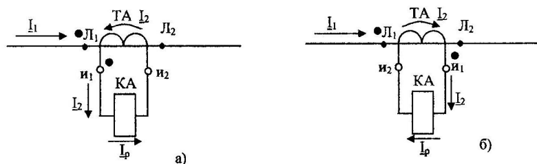
Рис. 1.7 Маркировка выводов ТТ
