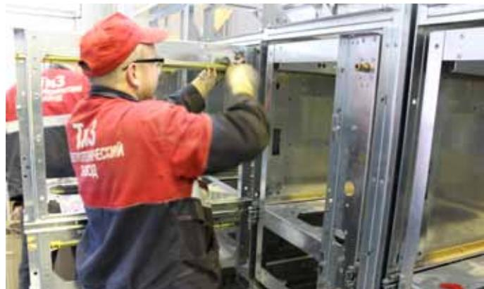
Конечный пункт производства - участок сборки комплектных трансформаторных подстанций. На данном участке ведущие специалисты осуществляют комплектацию БКТПБ - устанавливают необходимое электрооборудование, разводят системы учета АСКУЭ, монтируют пожарную и охранную сигнализацию, системы телемеханики и телесигнализации.
