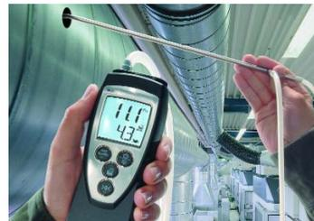
Дифференциальный манометр **testo 512\*\***
