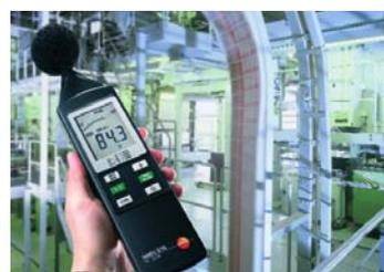
Шумомер 2 класса точности **testo 816\*\***
