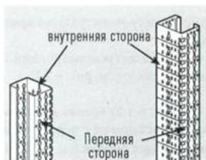
Рис. 6.1.1. Стороны перфорированных монтажных стоек
