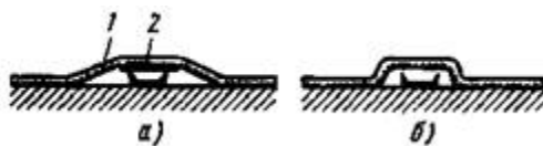
Рис. 1.1. Выполнение обхода препятствий проводом (жгутом проводов):
