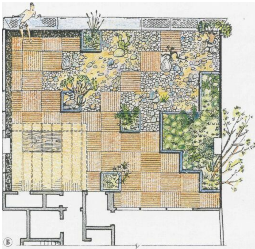
Растения на крыше размещаются в передвижных или стационарных (закрепленных в покрытии) контейнерах; посадки, занимающие большую площадь, обрамляются общим бетонным бордюром: А - общий вид; Б - план
