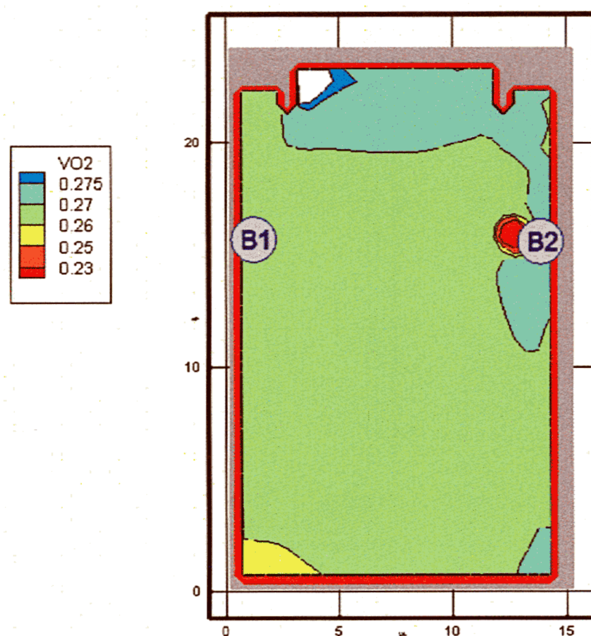
Рис. 95. Концентрация \text{O}_2 ( \text{кг}/\text{м}^3 ) в горизонтальном сечении на высоте 2,9 м от уровня пола в момент времени 230 с
