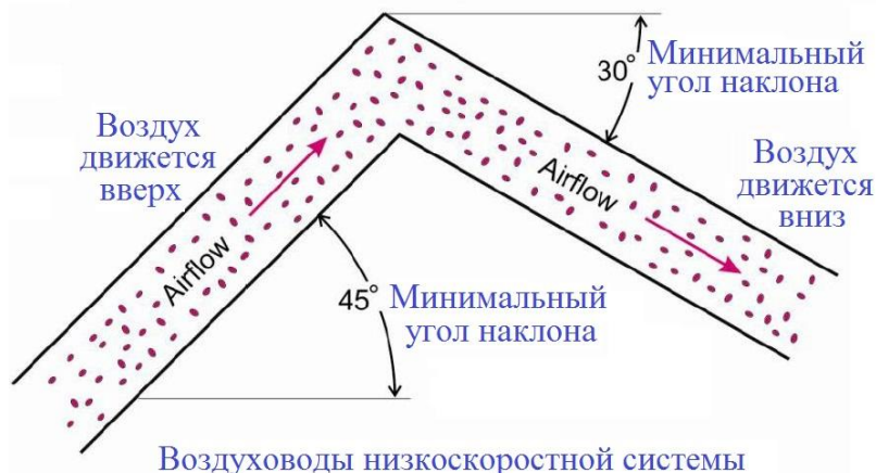
Рис. 1.11. Конструкция воздуховодов низкоскоростной обеспыливающей вентиляционной системы
