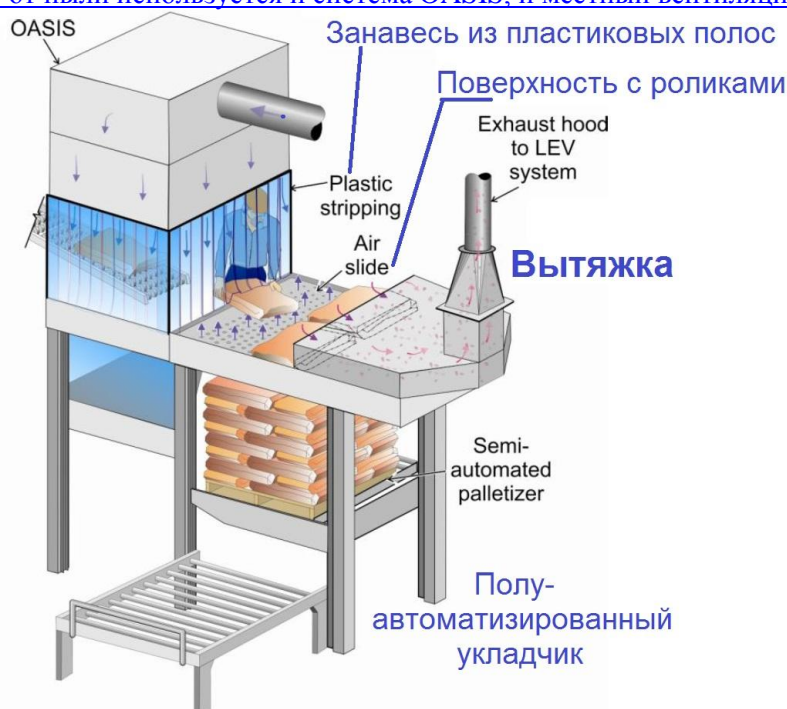
Рис. 6.16. Полу-автоматическая система укладки мешков. Рабочий перемещает мешок с конвейера, и укладывает их на поверхность в один слой, откуда они по завершении укладки перемещаются на паллету автоматически. Для защиты рабочего от пыли используется и система OASIS, и местный вентиляционный отсос
