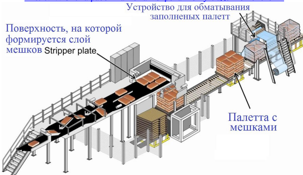
Рис. 6.17. Схема работы автоматизированной укладочной системы
