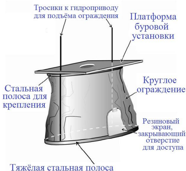
Рис. 3.6. Конструкция круглого ограждения
