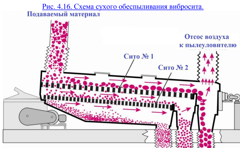
Рис. 4.16. Схема сухого обеспыливания вибросита
