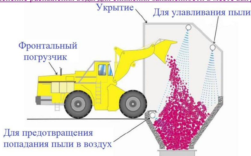
Рис. 2.10. Применение распыления воды для снижения запылённости в месте выгрузки материала
