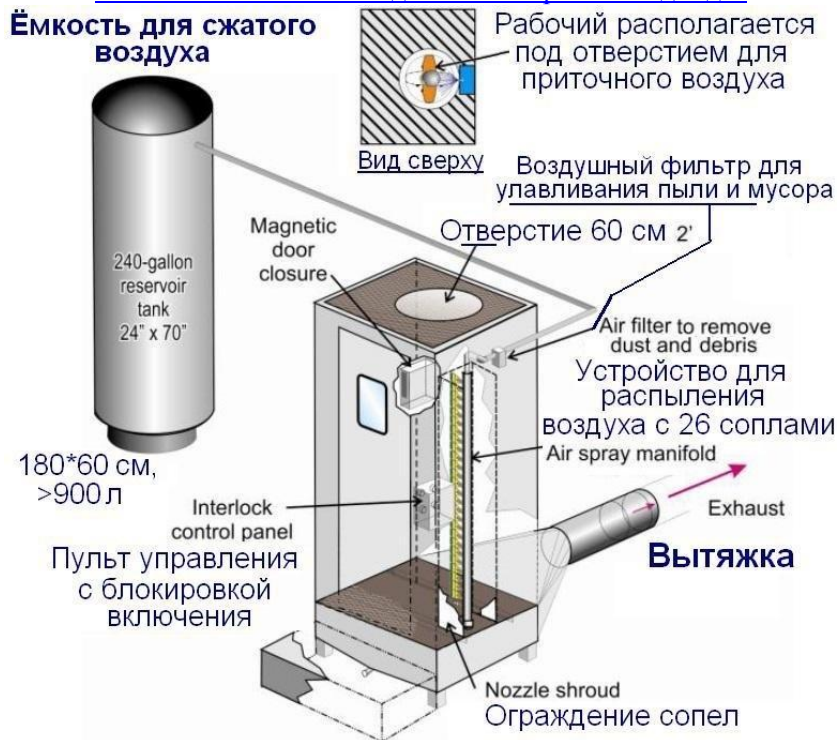
Рис. 8.1. Схема системы для очистки рабочей одежды
