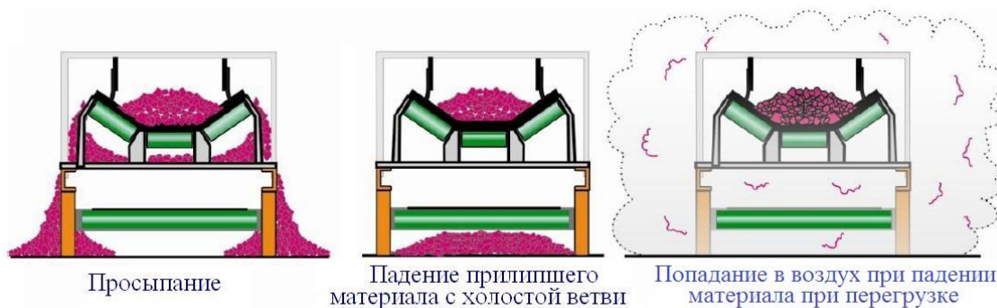
Рис. 5.2. Пути попадания пыли в воздух при перемещении материала ленточным конвейером.
