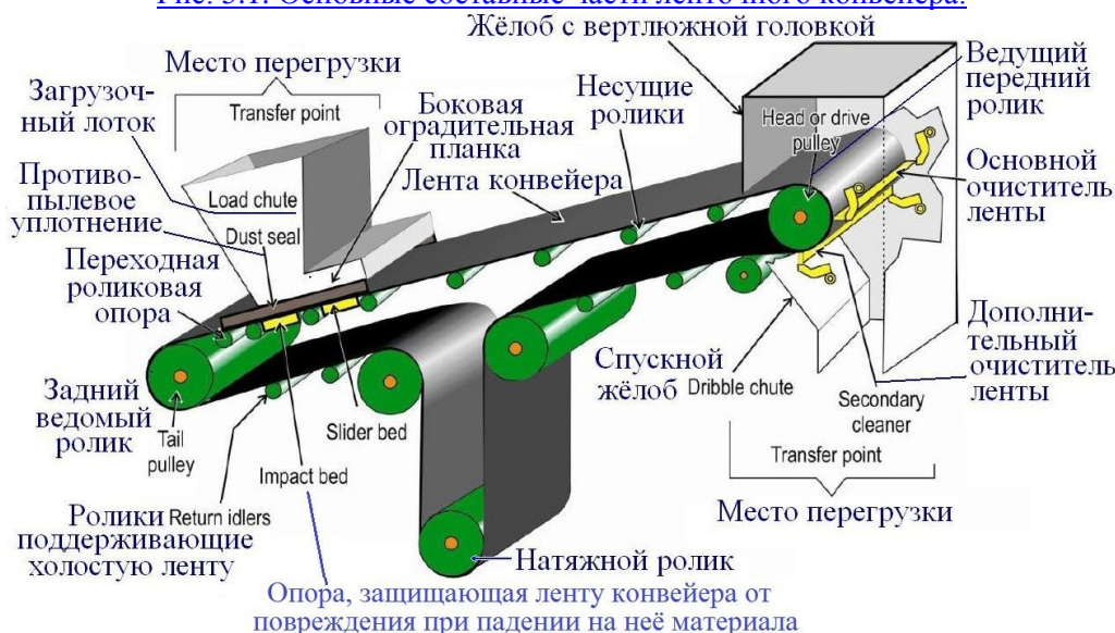
Рис. 5.1. Основные составные части ленточного конвейера.
