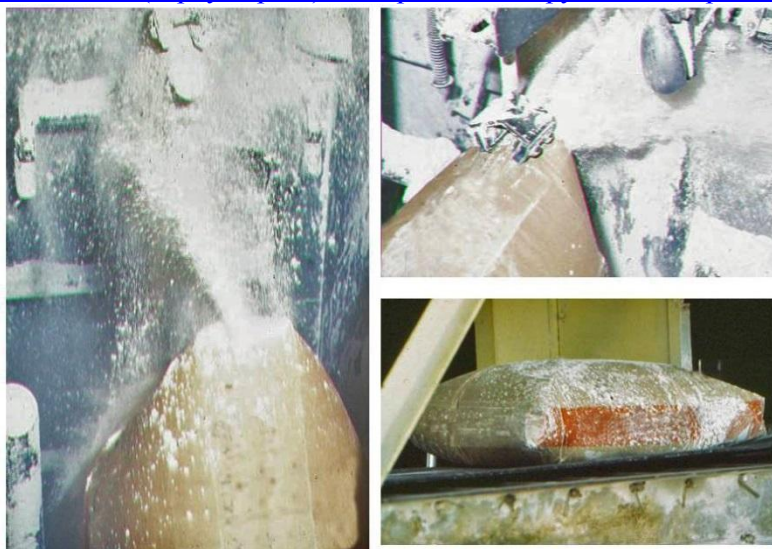
Рис. 6.1. Высыпание пыли (петушиный хвост) из загрузочного сопла (слева) обратный вынос запылённого воздуха при наполнении ёмкости (вверху справа) и загрязнение наружной поверхности мешка (внизу слева).
