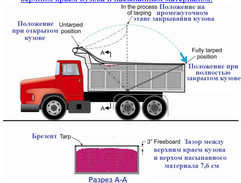
Рис. 10.9. Самосвал с приспособлением для накрывания груза брезентом. Голубая стрелка показывает направление движения (кронштейна) при накрывании. На разрезе А-А показан рекомендуемый зазор между верхним краем кузова и насыпанным материалом.
