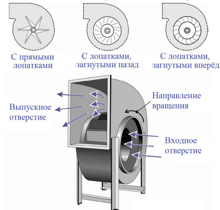
Рис. 1.30 Типичный радиальный вентилятор
