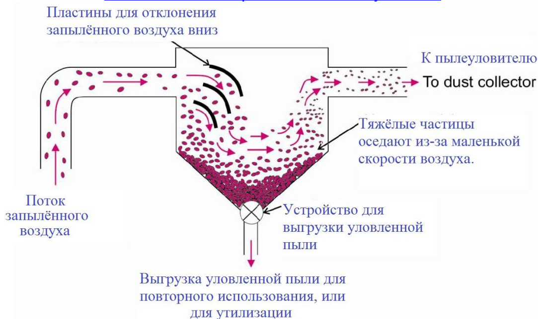
Рис. 1.14. Типичный гравитационный пылеуловитель
