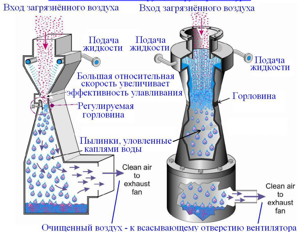
Рис. 1.22. Типичная конструкция скруббера Вентури
