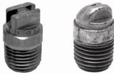
Рис. 2.19. Повреждение сопел форсунок - новая и использованная [SSCO 2003].
