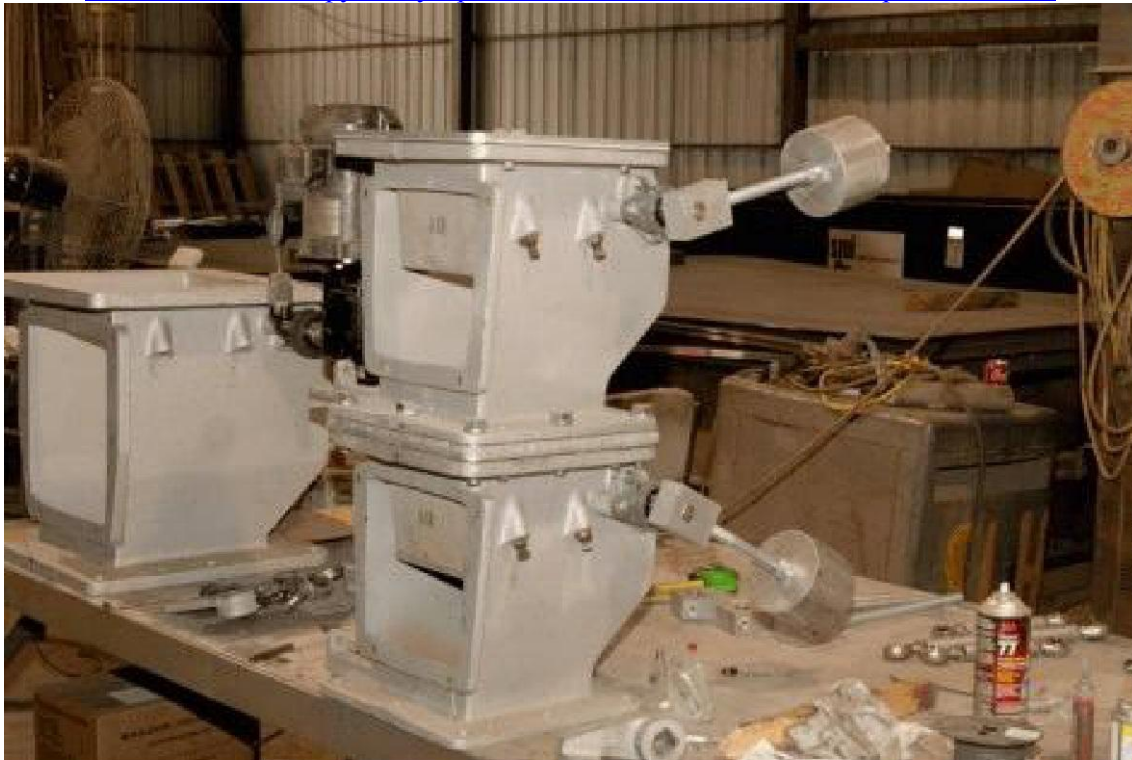
Рис. 1.24. Пылевывгрузное устройство типа двойная мигалка с противовесами
