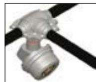
**Terminator ZP/FAK-5** Комплект для выполнения Т-образных разветвлений пучков трубок TubeTrace с электрообогревом. Эти комплекты предназначены для создания водонепроницаемого уплотнения на Т-образных стыковых соединениях трубок TubeTrace с электрообогревом.
